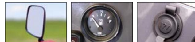
大型化したサイドミラー 燃料メータ 12V電源 (運転席操作パネル内)
